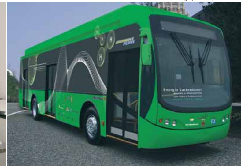
...artesanato e alimentação. À direita, ônibus elétrico híbrido a álcool desenvolvido no Laboratório de Hidrogênio
