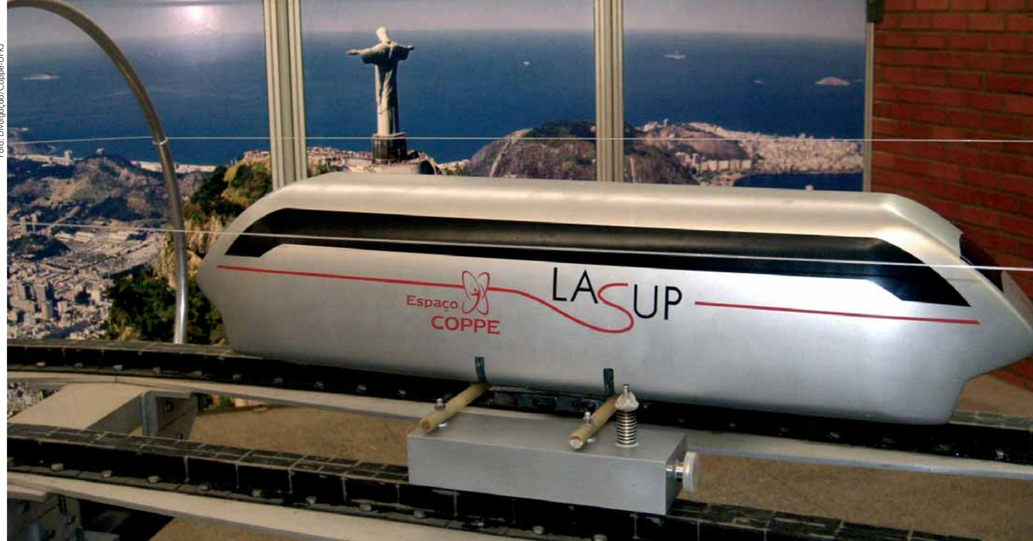
Maglev Cobra, trem magnético de baixa velocidade para uso em área urbana: ideal para vencer a topografia montanhosa do Rio
