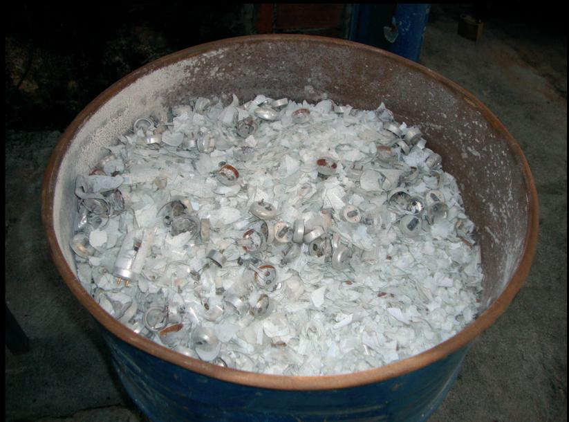
Lâmpadas trituradas, após descontaminação de mercúrio: em lugar do eventual descarte em lixões, material segue para reciclagem
