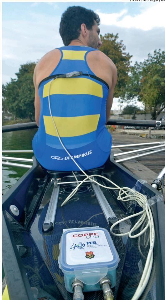
Aparelho instalado no fundo do barco monitora dados que indicam, com precisão, o desempenho físico dos remadores
