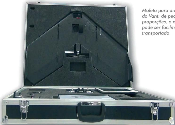
Maleta para armazenamento do Vant: de pequenas proporções, o equipamento pode ser facilmente transportado
