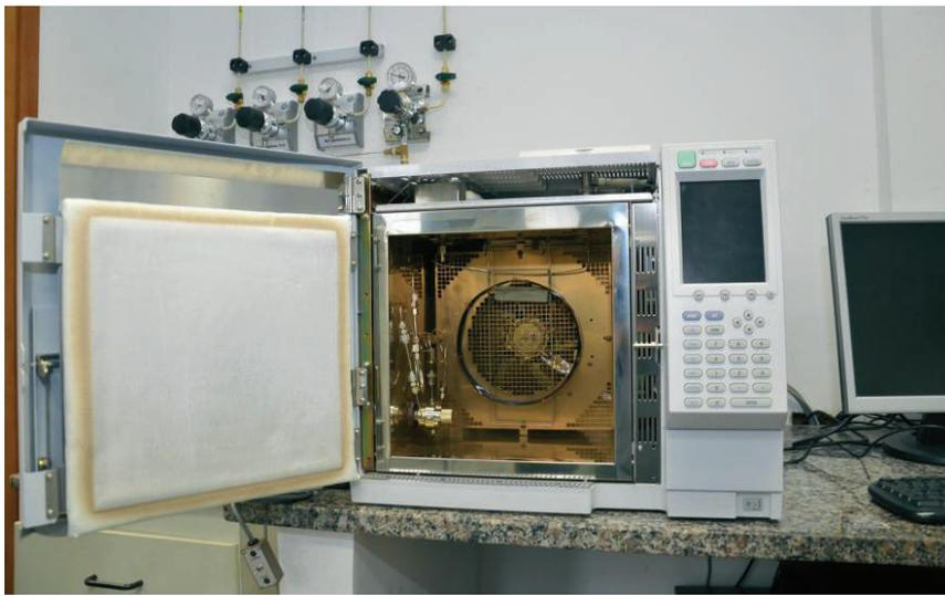
Cromatógrafo de gás (acima) e equipamento de deionização e purificação de água (ao lado): estudos visam proporcionar melhorias no desempenho de usinas hidrelétricas
