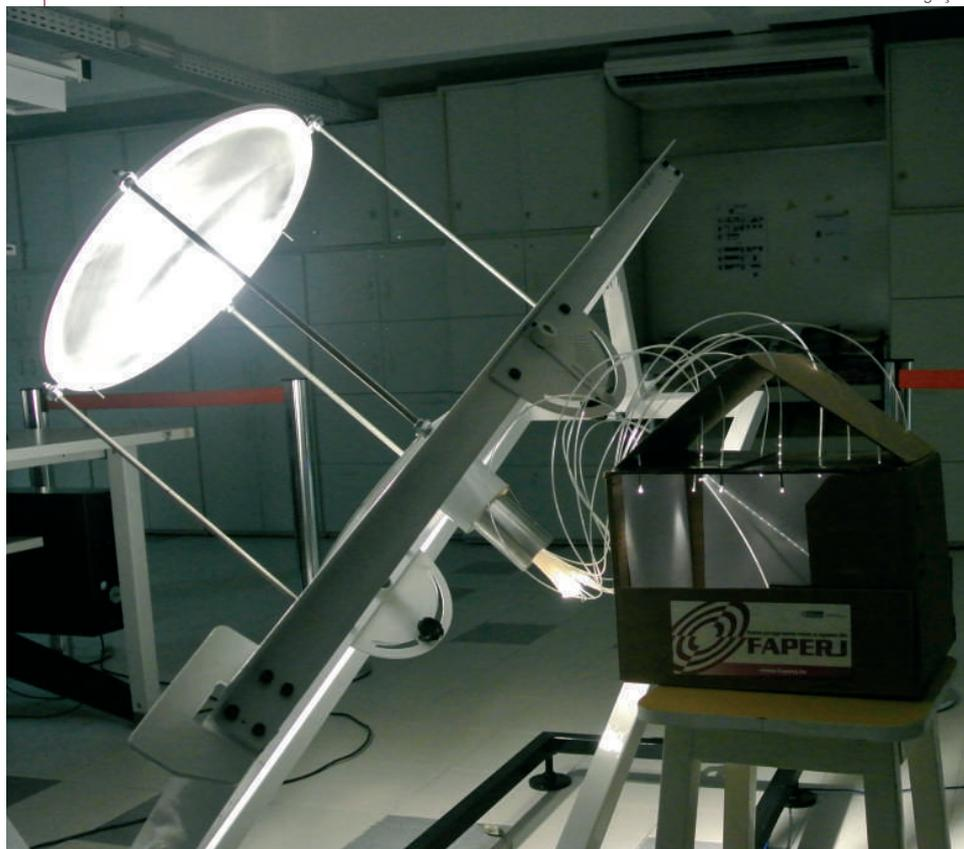
Protótipo do POF Lux: luz dirigida para os feixes de fibras ópticas é, em seguida, guiada e repartida para a parte superior da caixa de papelão, que simula o teto de uma residência
