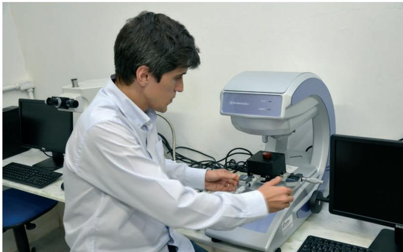
Daniel Jogaib, no Laboratório de Ensaios Mecânicos do IME, prepara equipamento para realizar ensaio de microdureza, a fim de avaliar a resistência mecânica dos biomateriais
