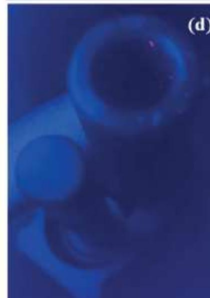
Imagens (a) e (c): Cartucho deflagrado e arma de fogo sob luz normal. Imagens (b) e (d): Cartucho e arma irradiados com luz ultravioleta, mostrando os compostos de lantanídeos, marcadores luminescentes
